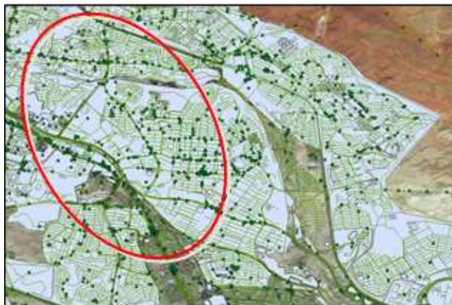
شکل ۱۲. آنالیز شبکه دسترسی محلی در منطقه ۵ با عرض بیش از ۶ متر برای مسیرهای دسترسی با بیشترین جابه‌جایی مسیر و حجم تردد
